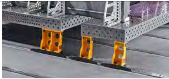
A felépített rendszer elemek eltolása emelőeszközök és daru alkalmazása nélkül lehetséges.
