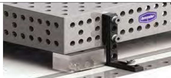
A felépítmények teher alatt is eltolhatók.
