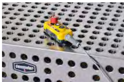
Praktikus kézi vezérlő a magasságbeállításhoz
