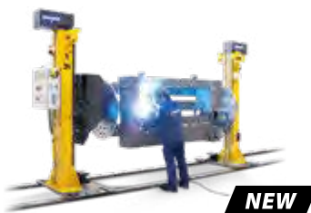
Robotix fordítóegység Közepes terhek fordításához és emeléséhez 2 t-től 14 t-ig
