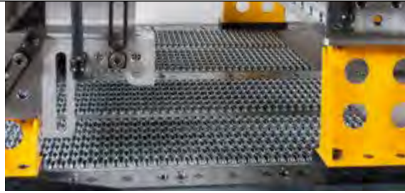
A felépítési magasságok a munkadarabhoz igazíthatók az asztallábak egyszerű cseréjével.
