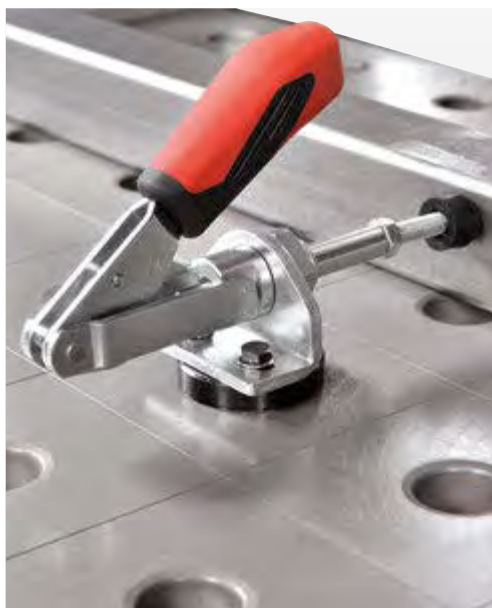
^ Tolórudas szorító adapterrel és süllyesztett fejű csavarral
